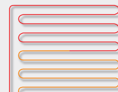
Posa a serpentina
