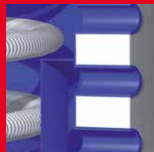
Einströmdämpfer verhindern eine Durchmischung der 2-Zonen-Schichtung im Speicher
