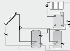
**Esempio 08:** Sistema solare con 2 accumulatori, logica di valvola e pompa di rialzo riflusso
