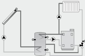
**Esempio 05:** Sistema solare con 1 accumulatore, pompa di rialzo riflusso e riscaldamento integrativo
