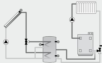
**Esempio 07:** Sistema solare con accumulatore a stratificazione e pompa di rialzo riflusso
