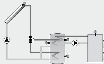
**Esempio 06:** Sistema solare con accumulatore a stratificazione e caldaia a combustibili solidi
